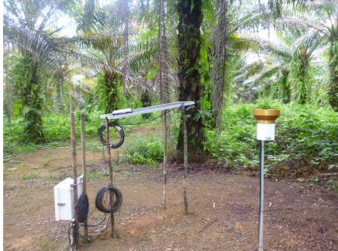
Figura 6. Monitoramento da precipitação e fatores microclimáticos do solo dentro do dendezal. CERU.
