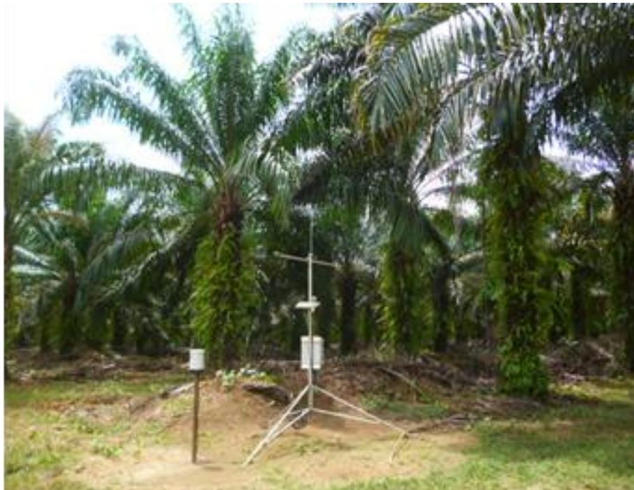
Figura 5. Micro estação meteorológica com sensor de temperatura e umidade do ar; velocidade e direção do vento; radiação solar e precipitação. CERU.
