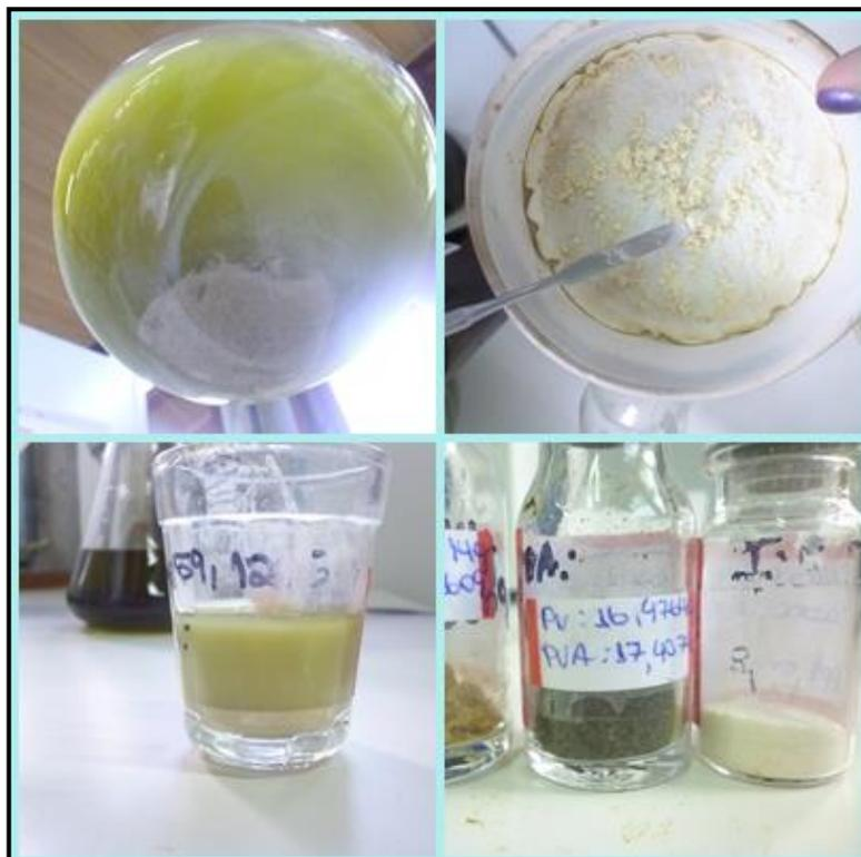
**Figura 16: Precipitação e lavagem do sólido branco proveniente do extrato de casca em acetona.**
