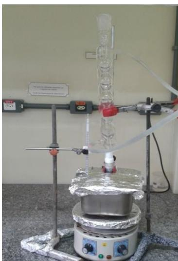
Figura 7. Sistema montado para a preparação dos catalisadores através do método de redução por etilenoglicol.
