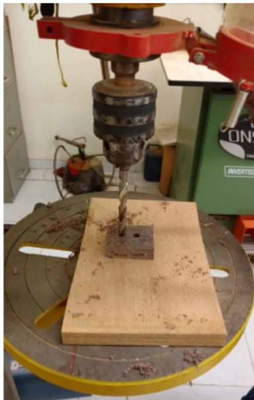
**Figura 9.** Furadeira horizontal de avanço manual utilizada nos ensaios de perfuração dos corpos de prova
