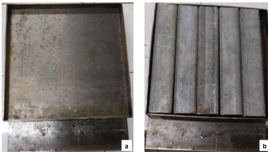
**Figura 3.** Molde utilizado na produção dos painéis
