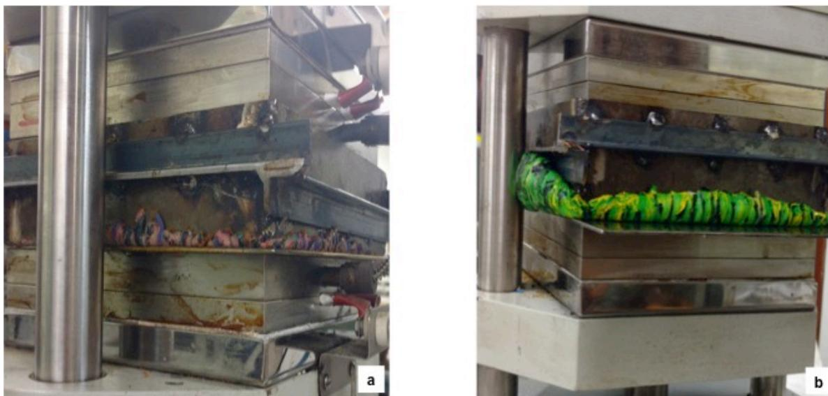
**Figura 11.** Fuga do material do tipo pedaço de lápis durante aquecimento
