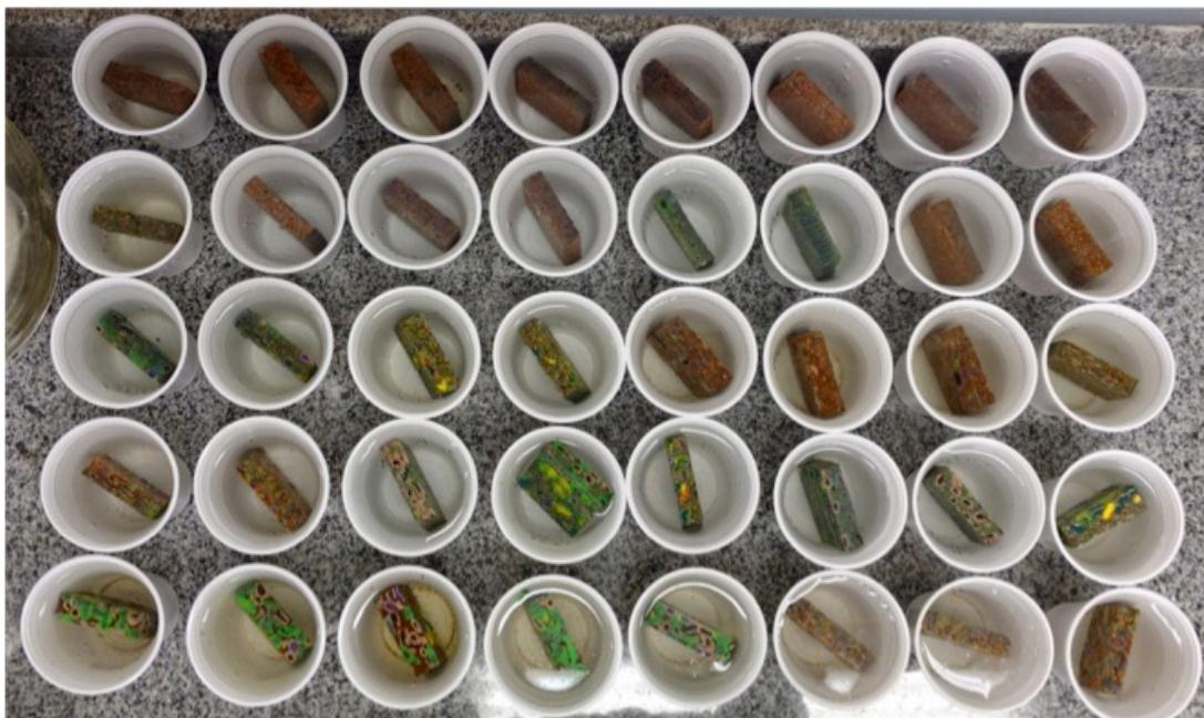
**Figura 19.** Corpos de prova imersos em água para ensaios de absorção de água e inchamento em espessura
