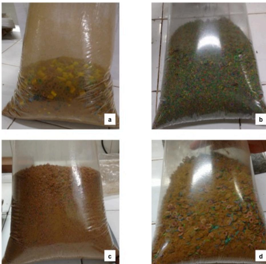
**Figura 10.** Homogeneização das partículas de serragem com poliestireno de diferentes dimensões
