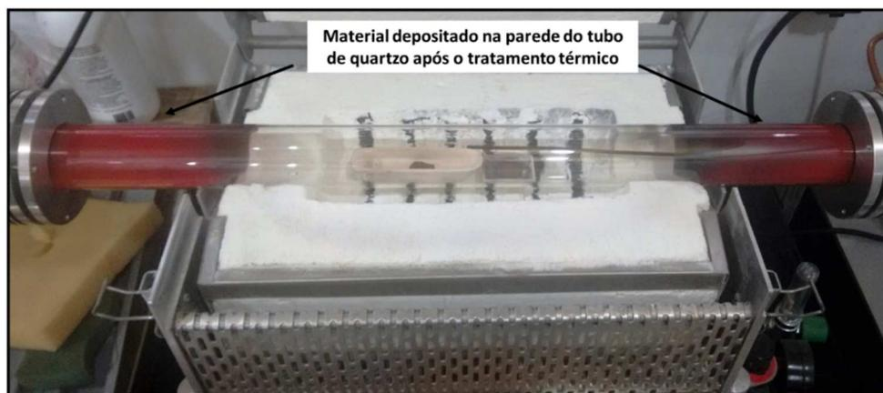
Figura 31 – Evidência visual da perda de massa na amostra com 1h de moagem, após um tratamento térmico a 400°C
