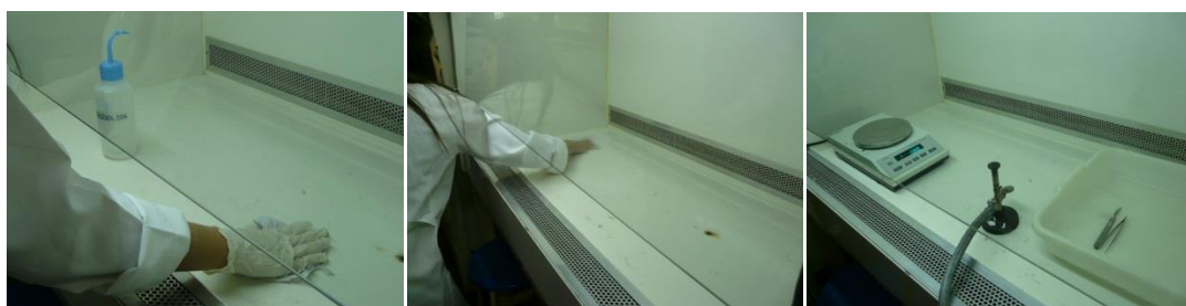
Figura 08. Processo de desinfecção da capela de fluxo laminar e dos equipamentos/materiais utilizados nas análises microbiológicas (Fotos: Silva Junior, 2013).
