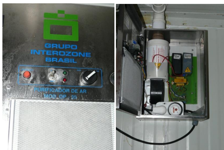
Figura 07: Vista frontal do aparelho formador de ozônio, fechado e aberto (Fotos: Silva Junior, 2013).
