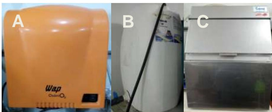
Figura 4. Máquina de ozônio de alta pressão utilizada para ozonizar a água (A); bombona plástica com capacidade de 50 litros utilizada para armazenamento da água ozonizada (B); máquina utilizada para fabricação do gelo (C).
