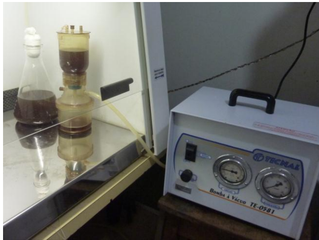
Figura 7 – Segunda separação por filtração (filtro 0,22 µm) sob vácuo das frações biomassa micelial e extrato lipolítico bruto.
