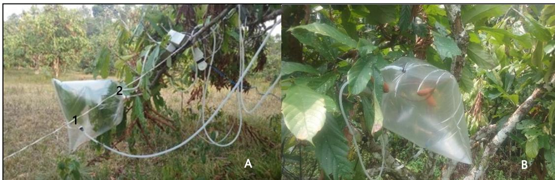
**Figura 1.2** A - Sistema de aeração de plantas utilizado para coleta de voláteis no campo. B- detalhe dos frutos acondicionados no saco plástico. 1. Entrada do ar, 2 saída para a bomba de vácuo, onde é conectado o adsorvente para a coleta de voláteis.
