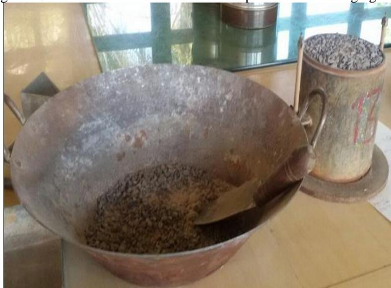
A determinação do teor de umidade ótima, ainda de acordo com Tango (1994), consiste em descobrir, através da introdução de pequenas quantidades de água a mistura seca, uma consistência propícia a moldagem de uma pelota de massa na mão, sem sujá-la consideravelmente (excesso de água), estabelecendo assim o fator água/cimento ideal para os blocos.
