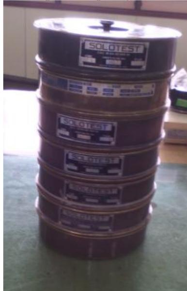
O conjunto (Figura 3.9) utilizado era composto pelas peneiras da série normal a partir da abertura de malha de 19,1 mm (ou  $\frac{3}{4}$ "), incluindo a de abertura de 12,5 mm (ou  $\frac{1}{2}$ "") da série intermediária.
