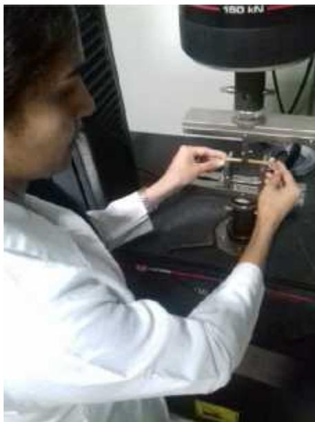
**Figura 8.** Osso da tíbia posicionados na Máquina Universal de Mecânica Eletrônica (Instron Modelo 5984).
