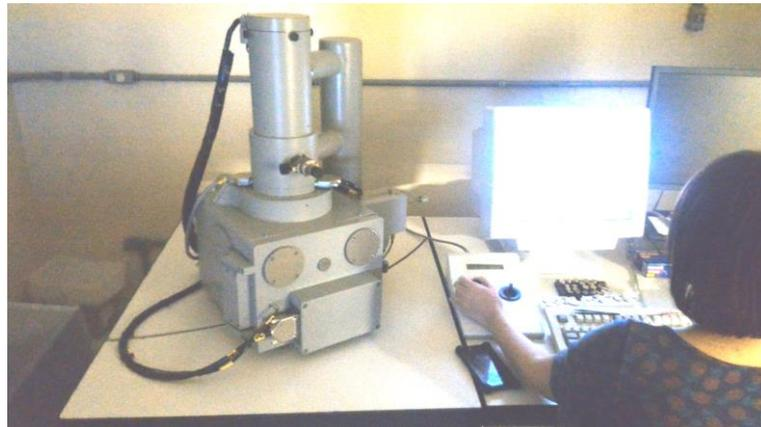
Figura 29 Equipamento de Microscopia Eletrônica de Varredura.
