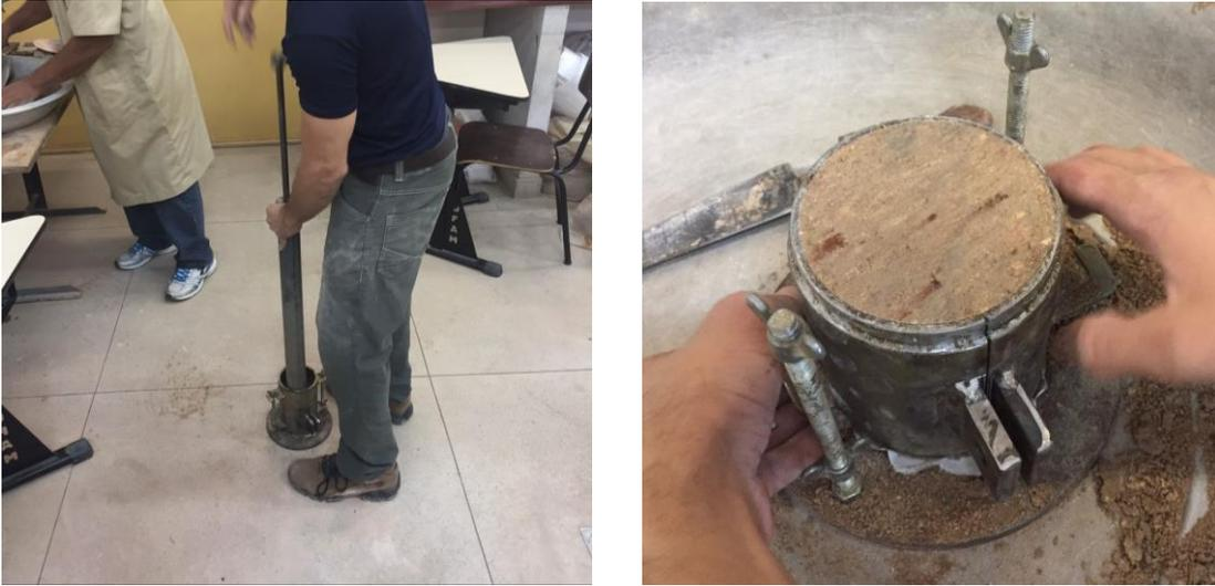
Figura 24 Procedimento de moldagem com detalhe no molde bi-partido preenchido com material compactado.
