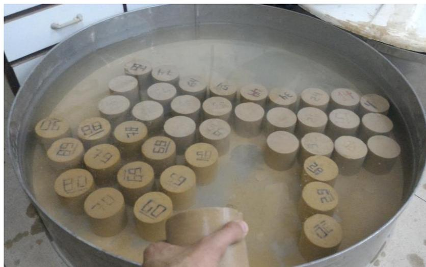
Figura 25 Condição de cura submersa.
