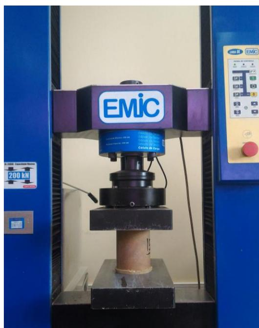
Figura 26 CP capeado levado à ruptura por compressão não confinada.
