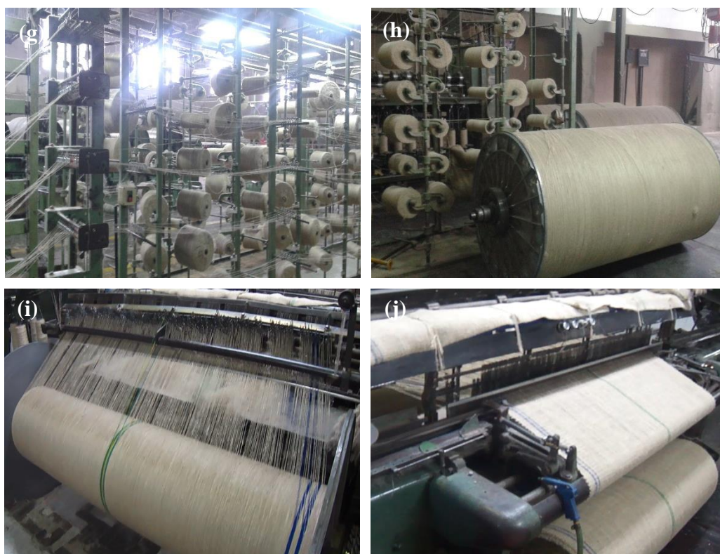
Figura A – Processo industrial de Beneficiamento das fibras de juta e malva: (a) fardo das fibras provenientes da produção na zonal rural amazense; (b) codicionamento das fibras para desfiamento; (c) e (d) limpeza das fibras e início do processo de desfiamento; (e) finalização do processo de desfiamento e acondicionamento em bobinas; (f) produção dos cordões; (g) condicionamento dos cordões em carretéis menores; (h) transferência dos cordões dos carretéis menores para maiores; (i) fios engomados nos teares e preparação para a fabricação do tecido; (j) costura da trama (cordas horizontais) e fabricação do tecido.
