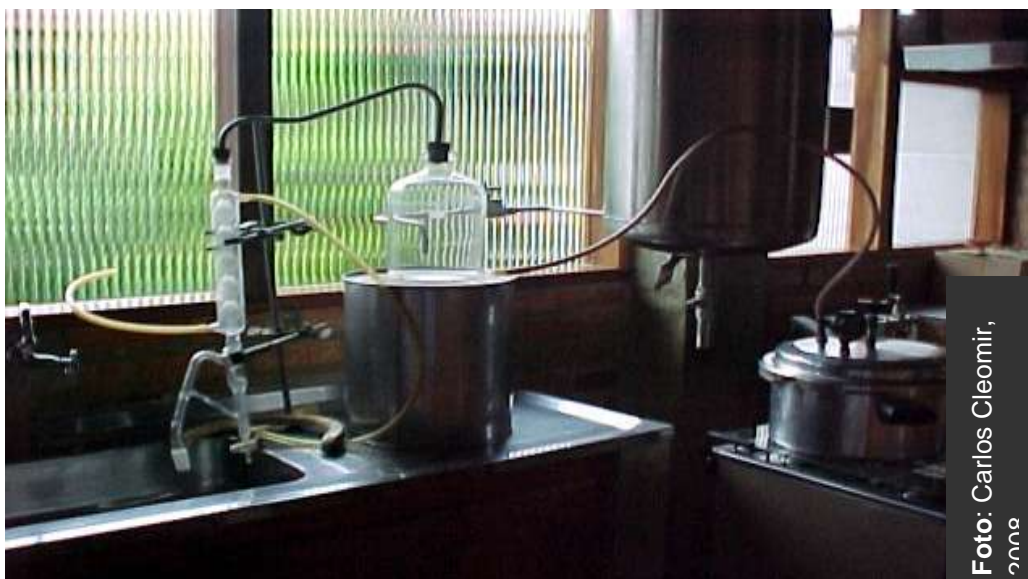
Figura 19. Extrator de óleo essencial por arraste-vapor utilizado na obtenção do óleo essencial de Z. zerumbet Smith.
