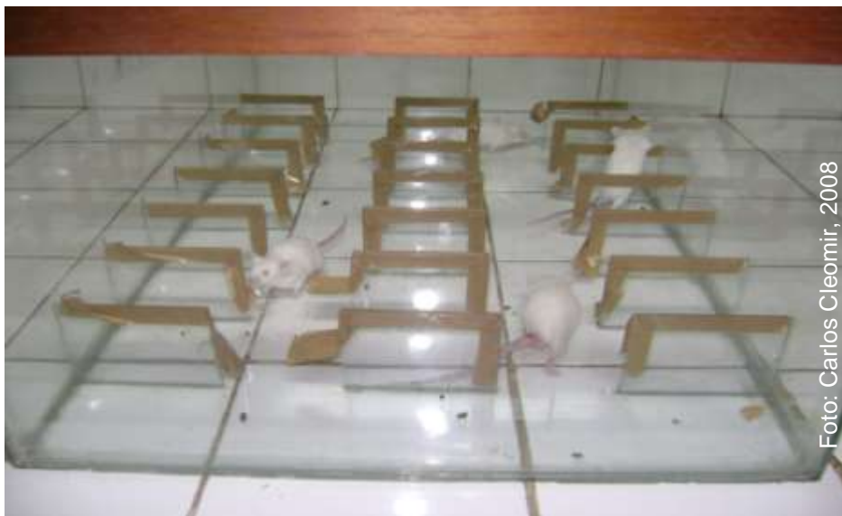
Figura 26. Aquário adaptado a medir a atividade exploratória de animais a nível campo aberto.
