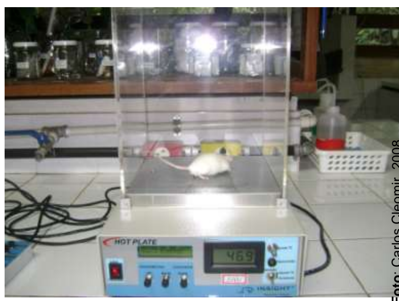
Figura 22. Aparelho HOT PLAT utilizado no modelo experimental de atividade analgésica.
