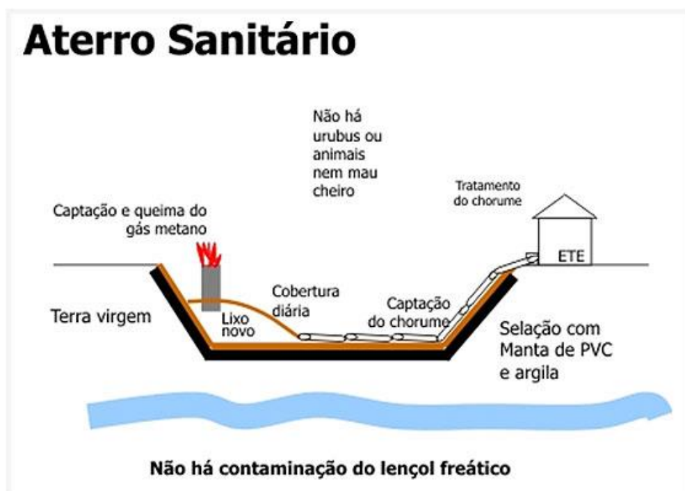
Figura 13 - Modelo esquemático de um aterro sanitário Fonte: Jogada Certa (2011)
