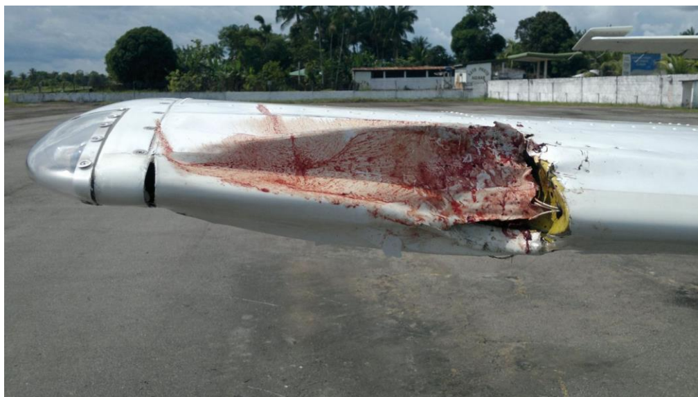
Figura 1 - Asa da aeronave parcialmente danificada por colisão com ave no município de Carauari-Am. Fonte: Portal do Holanda - < http://www.portaldoholanda.com.br/amazonas/urubu-estralcha-asa-de-aviao-no-amazonas-piloto-evita-tragedia >. Acesso em: 18/03/2016.
