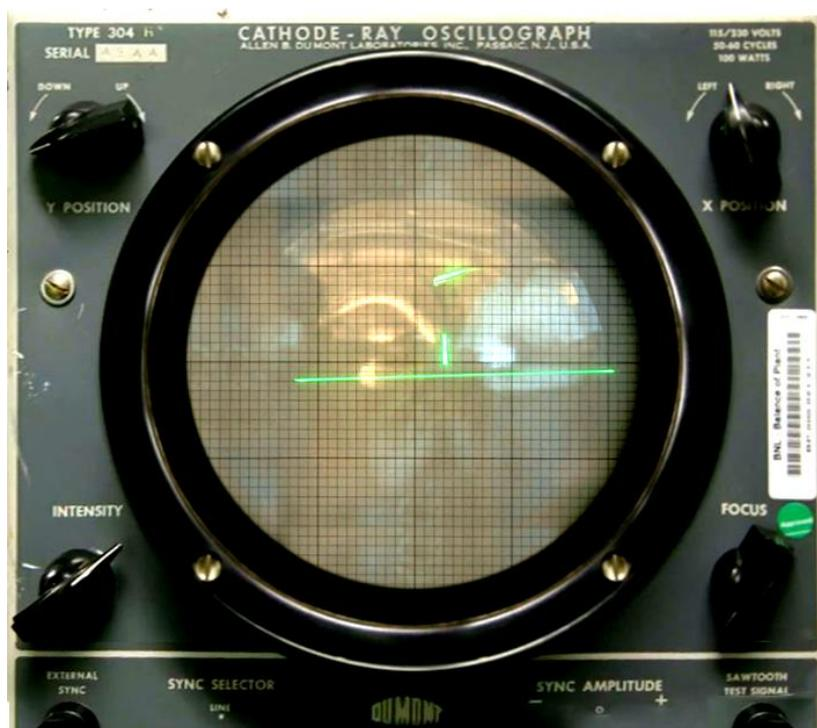
**Figura 2:** Uma recriação do protótipo de *Tennis for Two* desenvolvido por Higginbotham em um osciloscópio tipo 304-A do Laboratório DuMont.
