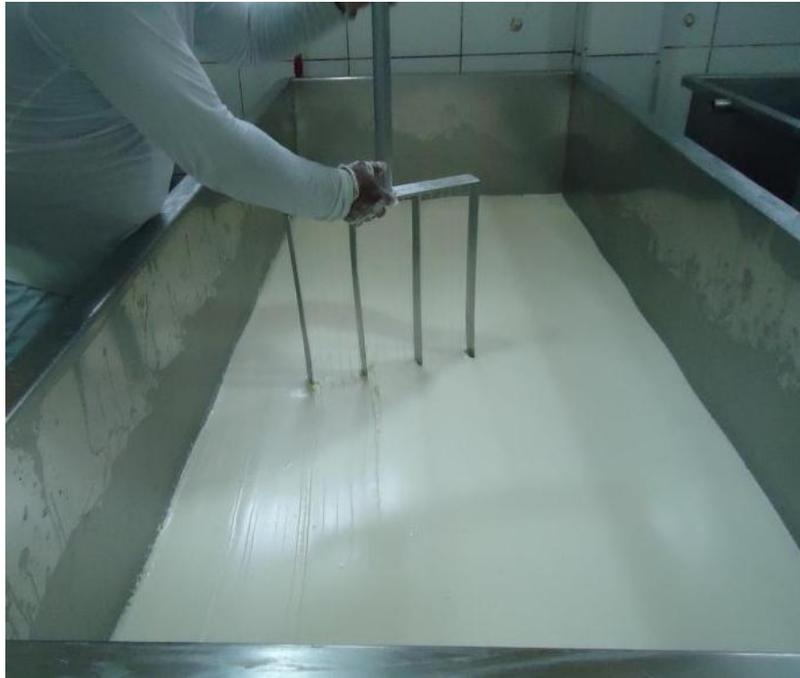
Figura 10. Corte da coalhada por lira de aço inoxidável Fonte: Organizado pelo autor (2017)
