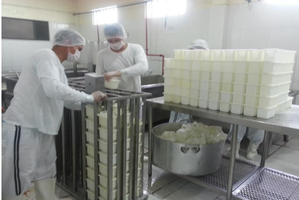
Figura 12. Processo de prensagem para retirada do soro Fonte: Organizado pelo autor (2017)
