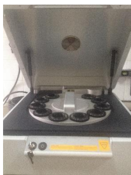
Figura 12. Espectrômetro utilizado para obtenção das composições químicas quantitativas.
