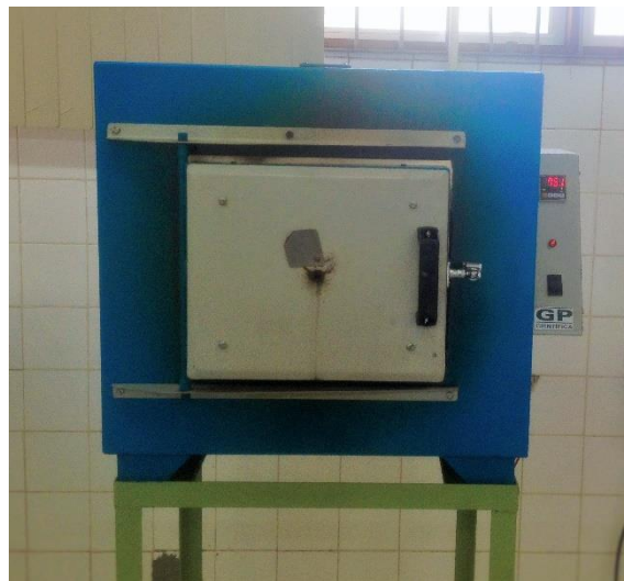
Figura 7. Mufla utilizada na calcinação do caulim.
