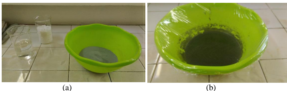
Figura 10. Materiais para preparo do silicato de potássio (a). Silicato durante o processo de esfriamento a temperatura ambiente (b).
