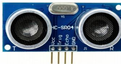
Figura 3-11: Sensor Ultrassônico HC-SR04.
