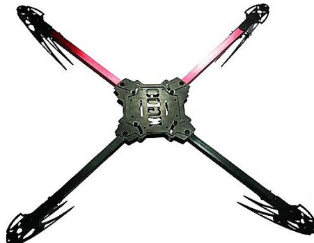
Figura 3-1: Estrutura mecânica do quadricóptero - Frame X600 .
