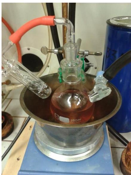
**Figura 6.** Reator contendo a mistura para obtenção do derivado de eugenol.
