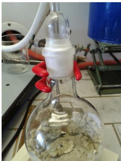
**Figura 7.** Reator ligado a bomba de vácuo para retirada do solvente.
