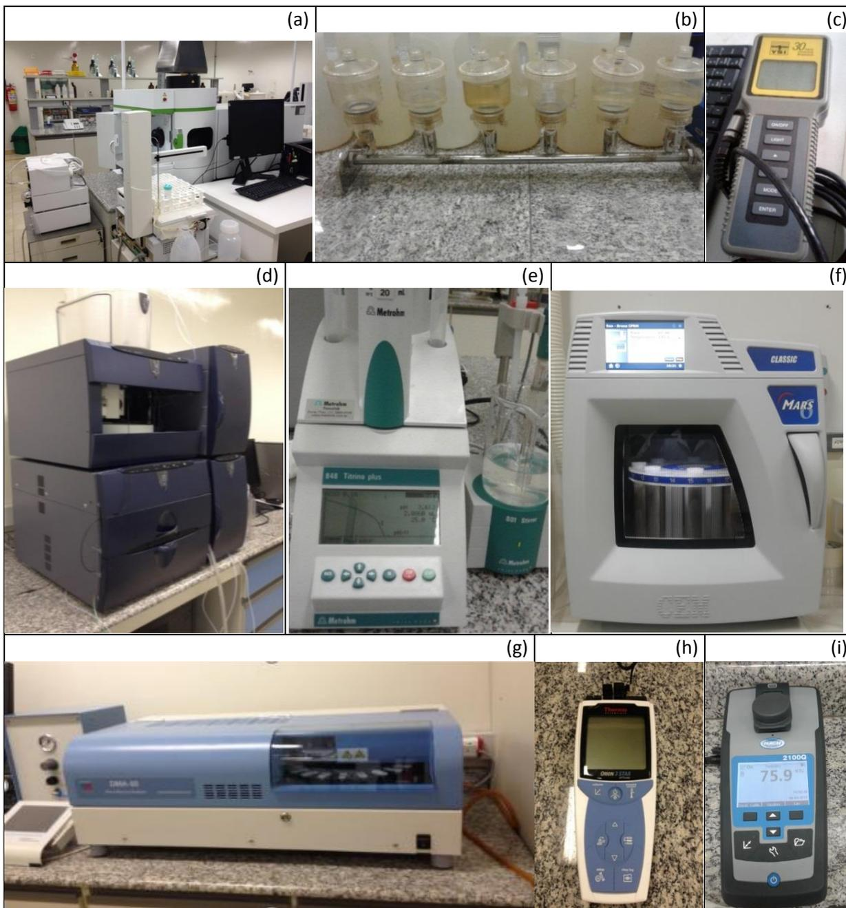
Figura 55- Equipamentos utilizados: ICP-OES Optima 8000 (a), Sistema de Filtração SM 16829 (b), Condutivímetro Ysi 30 (c), Cromatógrafo Iônico ICS-5000 (d), Titrimo 848 Plus (e), Microondas XP 1500 Plus (f), DMA-80 (g), pHmetro Oryon 3 Star (h) e Turbidímetro HACH 2100 Q (i).
