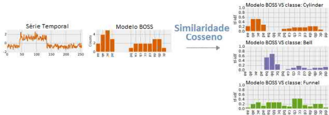
Figura 4.8. Classificação utilizando 1-NN e o modelo BOSS-VS. Fonte: Schäfer (2016) .
