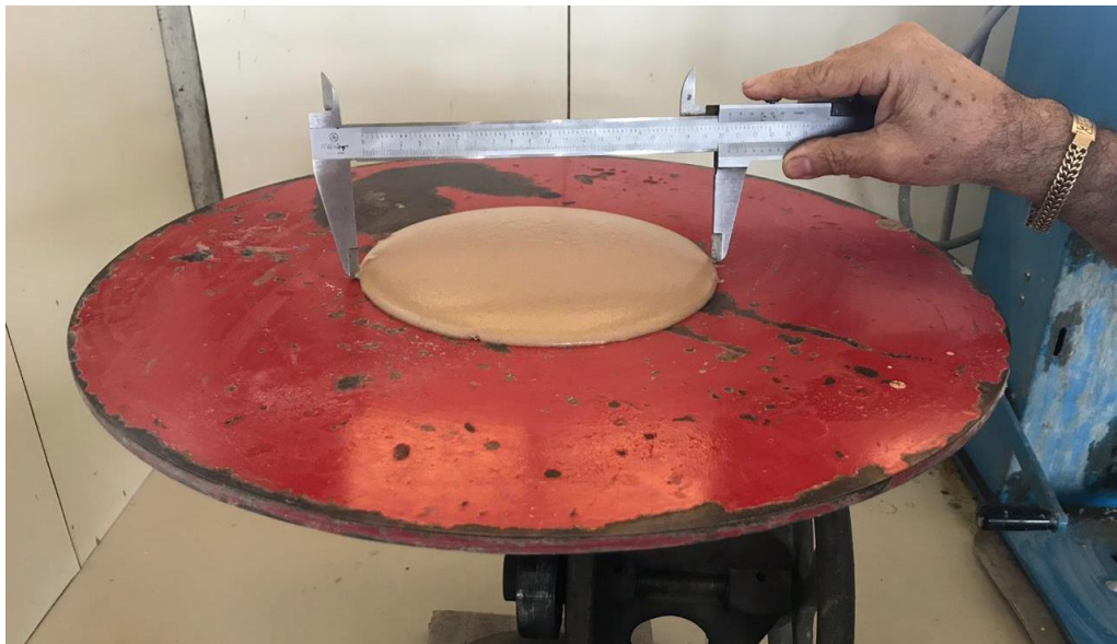
Fig. 5. Aparência da argamassa sobre a mesa de abatimento.
