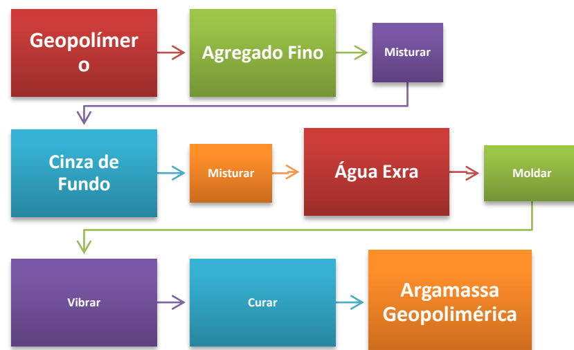
Figura 19 – Esquema de mistura da argamassa
