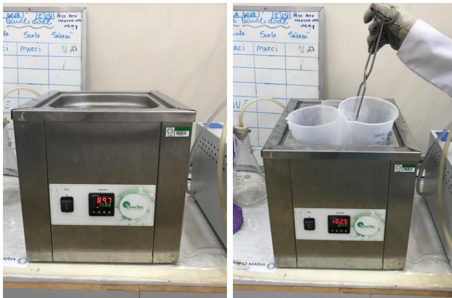
Figura 9 – Banho maria utilizado para a preparação do ativador alcalino
