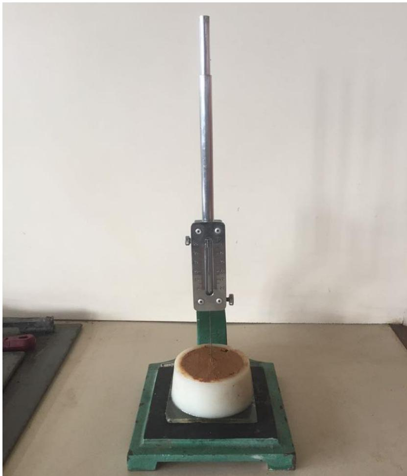
Figura 2.7 – Aparelho de Vicat utilizado para determinação do tempo de pega das pastas de geopolímeros.
