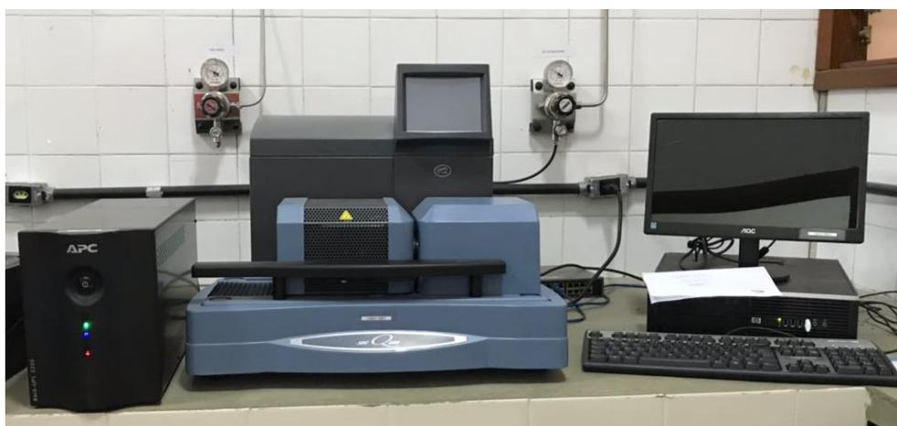
Figura 2.6 – Bancada de laboratório com equipamento de análise térmica do LAMAC/UFAM.
