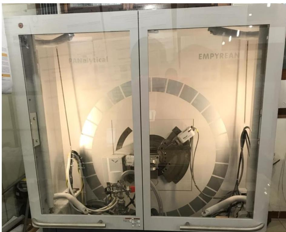
Figura 2.5 – Difratorômetro de raios x do LabMat/UFAM utilizado na caracterização mineralógica e identificação dos argilominerais.
