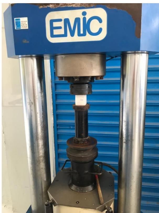
Figura 2.8 – Máquina universal de ensaio utilizada para romper os corpos de prova de geopolímeros por compressão.
