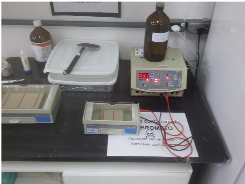
**Figura 2.6:** Equipamento de eletroforese do laboratório de fitopatologia da UFAM
