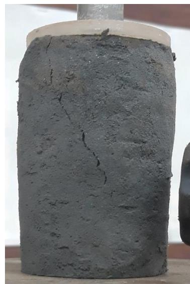
**Figura 78:** Corpo de prova do solo "cinza" após ensaio de compressão simples não confinada.
