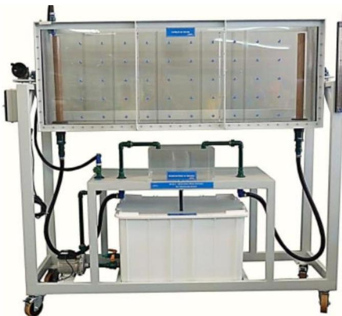
**Figura 33:** Bancada de Ensaios de Permeabilidade.
