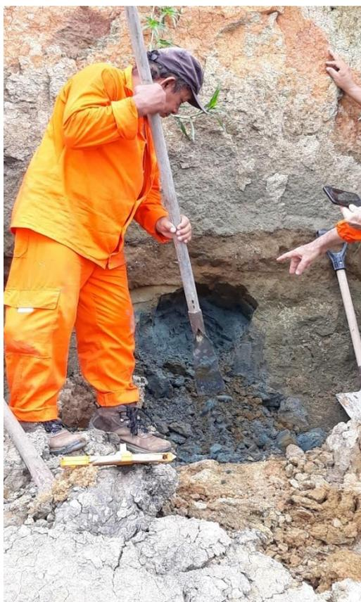
**Figura 61:** Abertura da cava para coleta do solo "Cinza".
