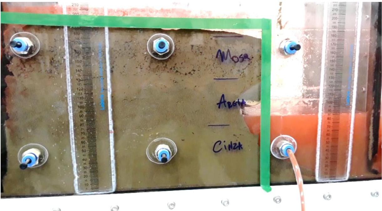
**Figura 96:** Aumento da erosão da camada de areia, deixando a camada de solo "mosqueado" em balanço.
