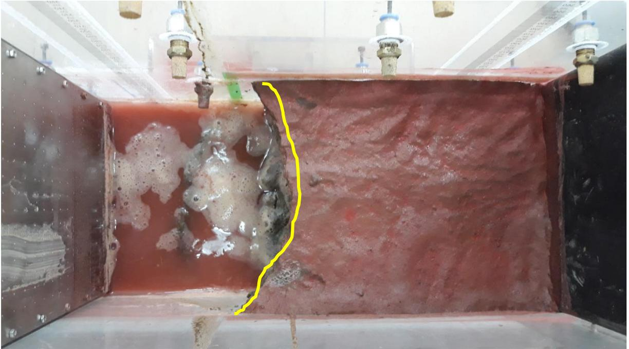
**Figura 99:** Vista superior do maciço, formação da cunha de deslizamento e drenagem até o centro da camada de solo "cinza".
