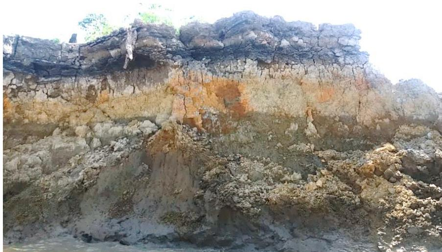
**Figura 46:** Imagem das camadas que serão modeladas na reconstrução do fenômeno em laboratório. Novamente há destaque à argila vermelha e as variações perceptíveis da umidade.
