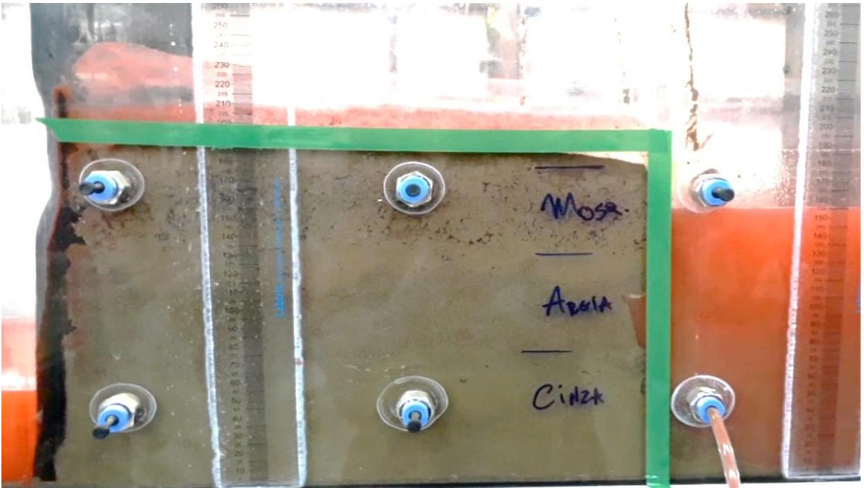
**Figura 94:** Remoção da placa permeável do modelo e início da erosão da camada arenosa.
