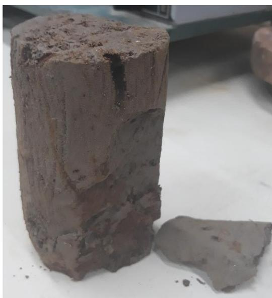
**Figura 77:** Corpo de prova do solo "mosqueado" após ensaio de compressão simples não confinada.
