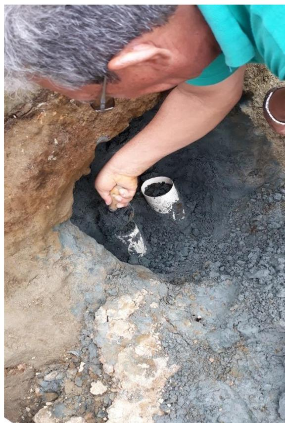
**Figura 60:** Coleta de amostras indeformadas em tubos de 75mm e 100mm na razão de 1 para 2 (d/h). Similar procedimento foi replicado às demais amostras coletadas.
