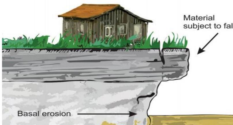
**Figura 7:** Esquemático do desabamento.
