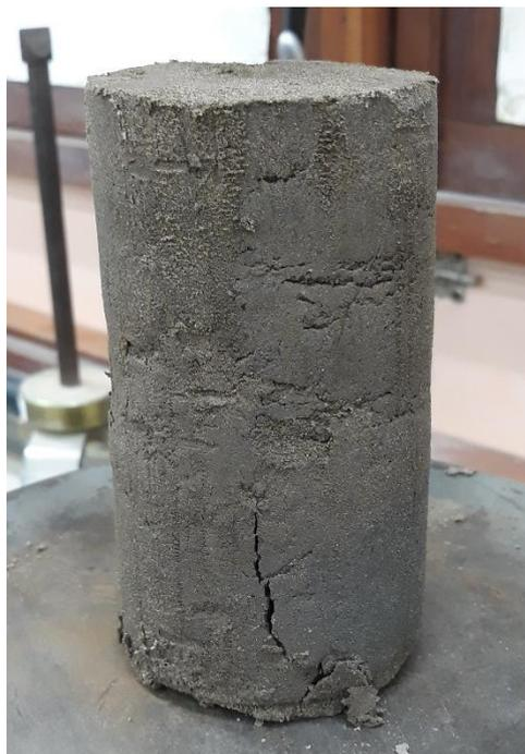
**Figura 79:** Corpo de prova do solo "areia" após ensaio de compressão simples não confinada.
