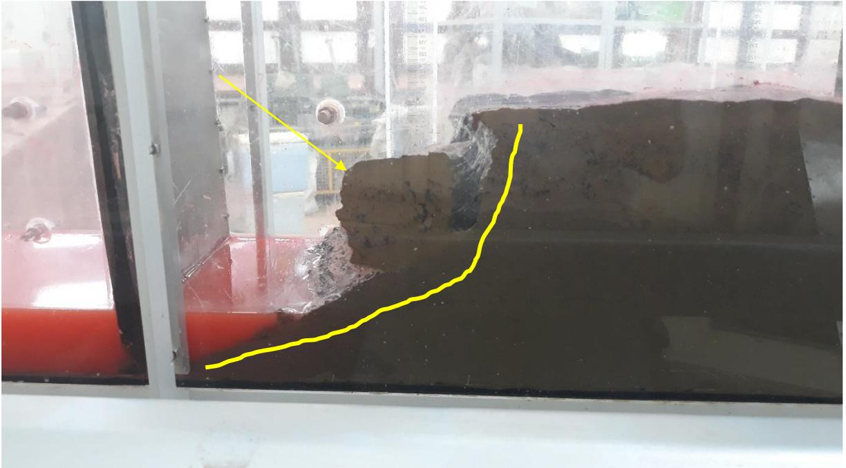
**Figura 92:** Movimento de escorregamento. Observa-se que o movimento de fato formou uma cunha (em destaque) na margem remanescente e preservou-se uma parte do maciço, após a descida das águas, a exemplo daquilo que ocorre na figura 3, sobre o escorregamento que ocorre na vazante do rio (perfil esquemático).
