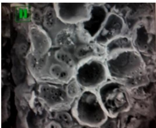
**Figura 5.** Microimagem de carvão ativado com uma morfologia de superfície onde é possível inferir a existência de poros de diferentes tamanhos.
