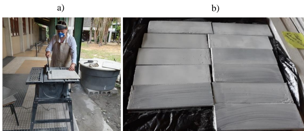
Figura 33: Corte das placas (a) e amostras após pintura com tinta branca (b).
