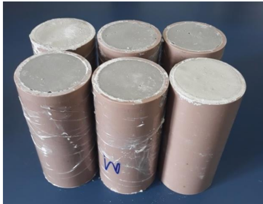
Figura 27: Moldagem dos corpos de prova para compressão.
