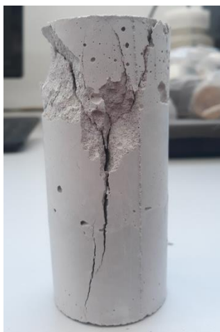
Figura 44: Modo de fratura dos corpos de prova submetidos à compressão.
