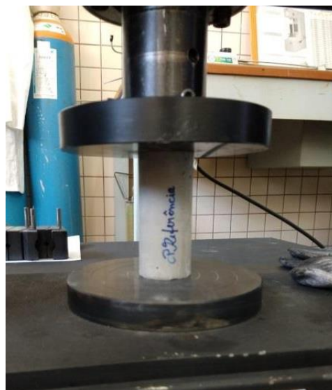
Figura 28: Corpo de prova à compressão.
