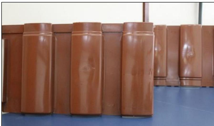
Figura 4 - Telha PET que compõe a cobertura da estrutura analisada.
