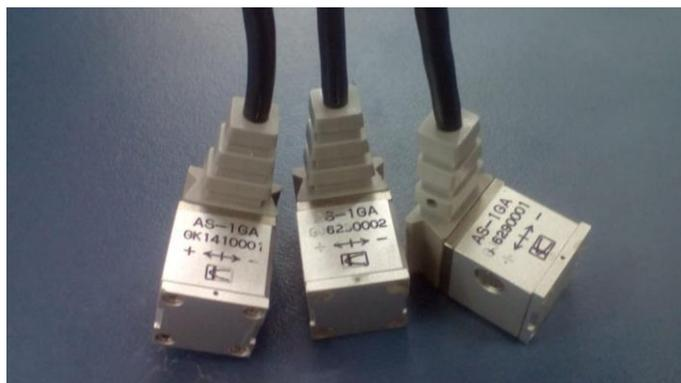
Figura 17 – Acelerômetros empregados na análise experimental dinâmica.
