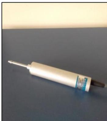
Figura 12 - Sensor de deslocamento (LVDT)
