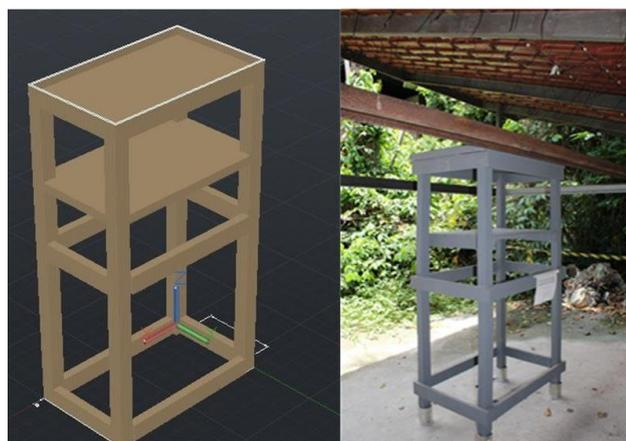
Figura 15–Aparato de apoio modelo virtual na esquerda e a direita o modelo real
