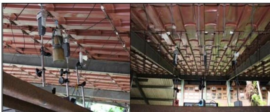
Figura 22 - Peso com mecanismo de fixação, apoios e relógios comparadores.
