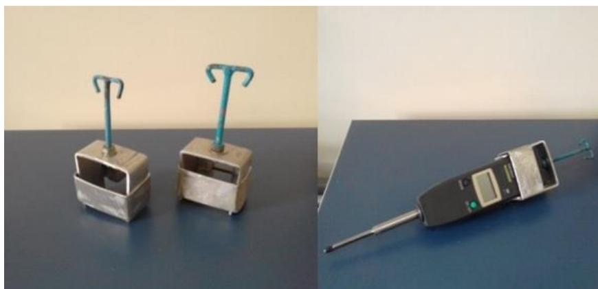
Figura 14– A direita os mecanismos de fixação e a esquerda o mecanismo já acoplado
