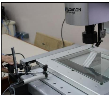
Figura 18- Calibração do LVDT pela MMC no Laboratório de Metrologia da UFAM.
