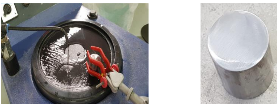
Figura 11. Esquerda – politriz e Direita – corpo de prova polido.
