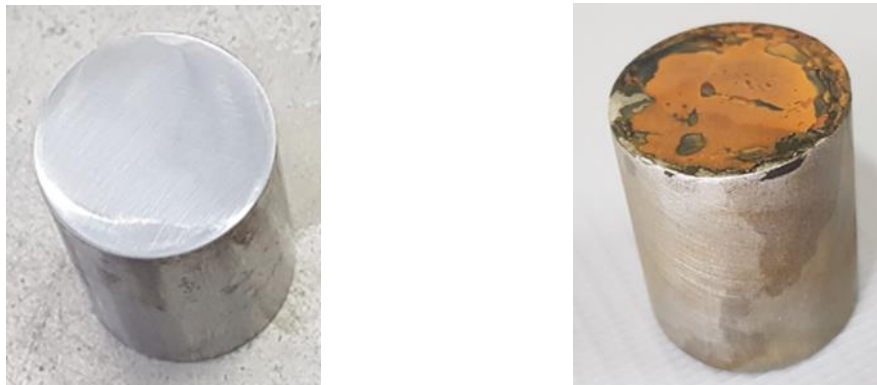
Figura 23. Amostra de tarugo de aço. Esquerda - antes da exposição ao tratamento 1 e Direita – após 30 dias de exposição ao tratamento 1.
