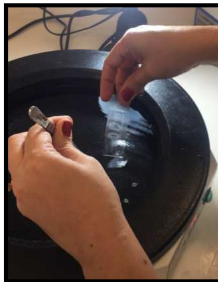
Figura 45b – Incorporação do corte em lâmina.
