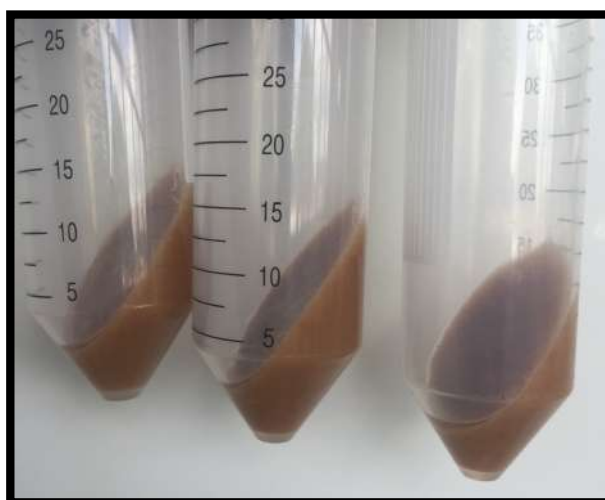
Figura 49 – Teste de centrifugação da pomada com separação de fases (tempo 0).
