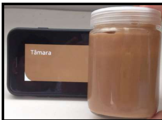
Figura 71 – Determinação da cor através da escala de cor Coral®.
