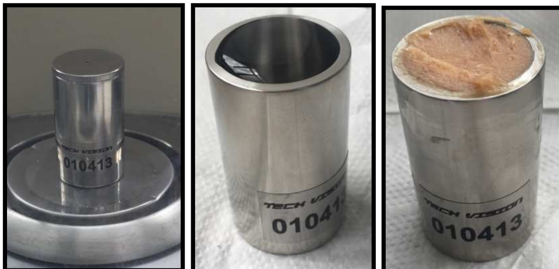
Figura 24 – Picnômetro vazio. Figura 25 – Picnômetro com água. Figura 26 – Picnômetro cheio.
