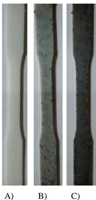
Figura 13. Corpos de prova obtidos no processo de injeção plástica. Sendo A) HIPS, B) compósito M2,5 e C) compósito M5.
