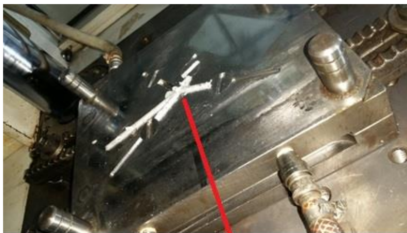
Rebarba de material
