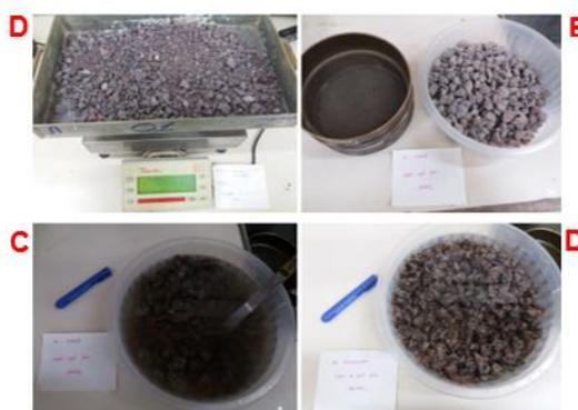
Figura 21. Ensaio de Teor de Material Pulverulento NBR NM 46/2003 no Laboratório de Pavimentação – LABPAV da UFAM.
