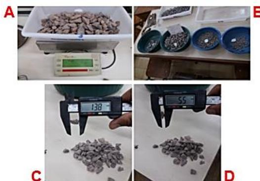
Figura 18. Ensaio de Índice de formas NBR 7809/2008 no Laboratório de Pavimentação – LABPAV da UFAM.
