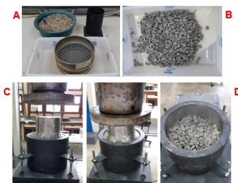
Figura 26. Ensaio de resistência pelo método dos 10% finos DNER-ME 096/1988 e de esmagamento NBR NM 9938/2013.
