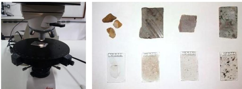
Figura 15. Lâminas petrográfica das amostras para análise mineralógica NBR NM 7389/2009
