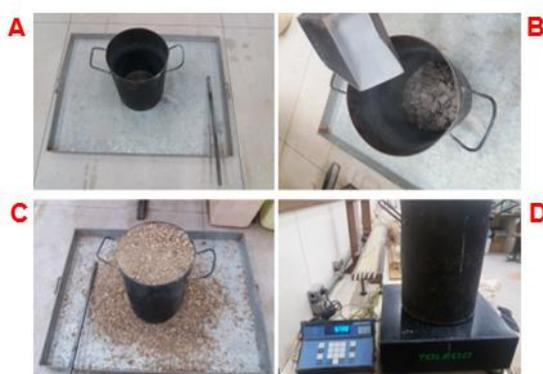
Figura 20. Ensaio de Massa Unitária solta e compactada NBR NM 45/2006 no Laboratório de Pavimentação – LABPAV da UFAM.
