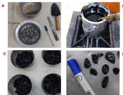
Figura 22. Ensaio de adesividade do agregado com o ligante betuminoso NBR 12583/2017 no Laboratório de Pavimentação – LABPAV da UFAM.
