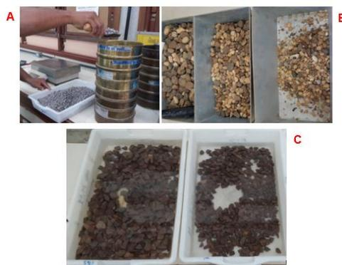
Figura 24. Ensaio de Teor de argila NBR 7218/2010 realizado no Laboratório de Pavimentação – LABPAV da UFAM
