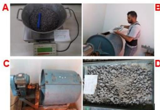
Figura 17. Ensaio de Abrasão Los Angeles NBR NM 51/2001 no Laboratório de Ensaios Físico-químicos – LEM da UFAM
