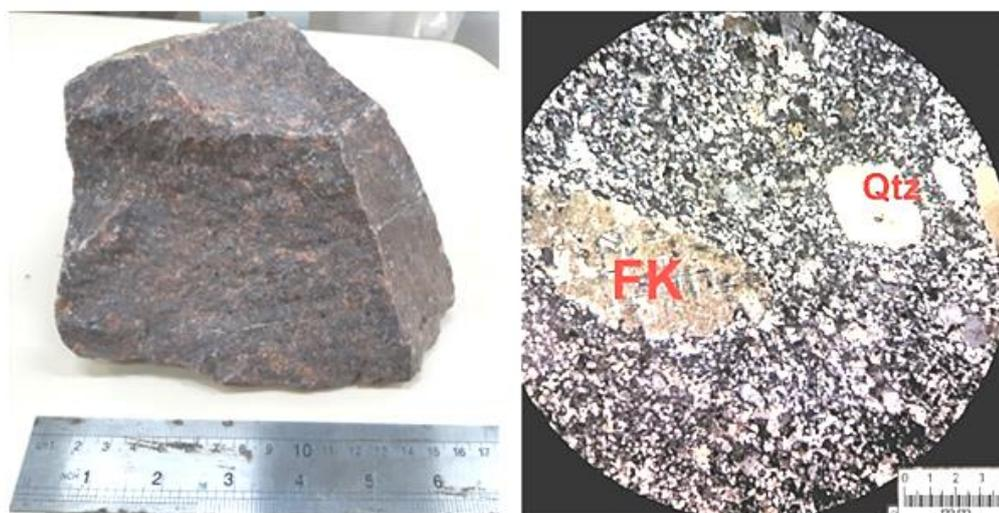
Figura 30. Lâmina petrográfica da amostra de brita BPF-2 em microscópio binocular modelo Leica DM 750P com Ampliação de 100x, realizado no laboratório de Microscopia do Departamento de Geociências – DEGEO.
