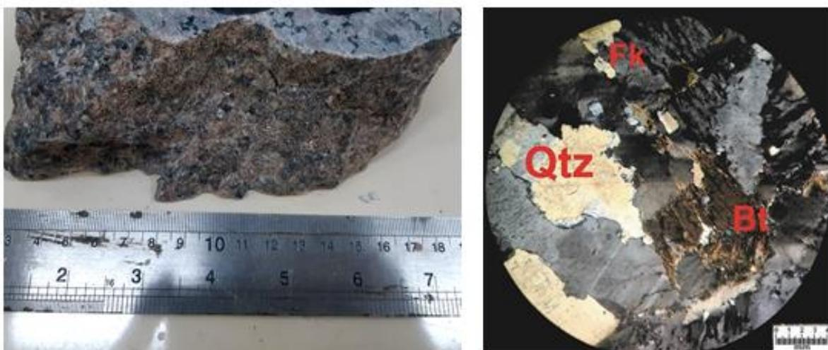
Figura 31. Lâmina petrográfica da amostra de brita BPF-3 em microscópio binocular modelo Leica DM 750P com Ampliação de 100x, realizado no laboratório de Microscopia do Departamento de Geociências – DEGEO.
