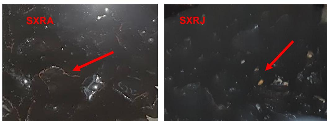
Figura 45. Escorregamento da película de ligante das amostras de seixo SXRA (a esquerda) e SXRJ (a direita).
