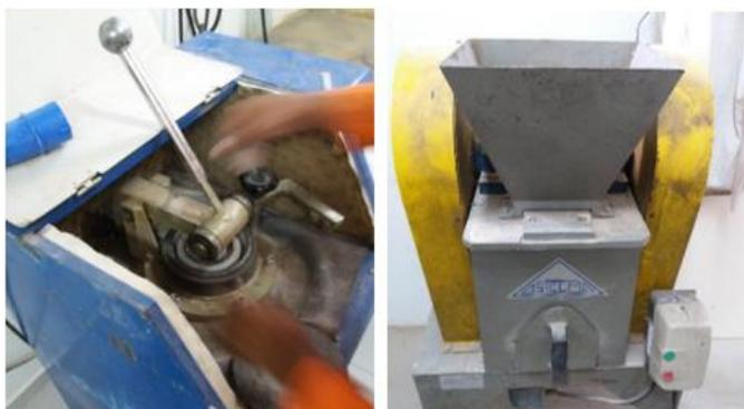
Figura 14. Equipamentos utilizados no preparo das amostras para ensaio de FRX e DRX.
