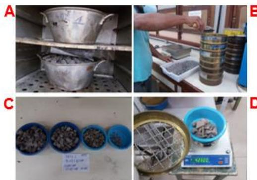
Figura 16. Ensaio de Análise Granulométrica NBR NM 248/2003 no Laboratório de Pavimentação – LABPAV da UFAM
