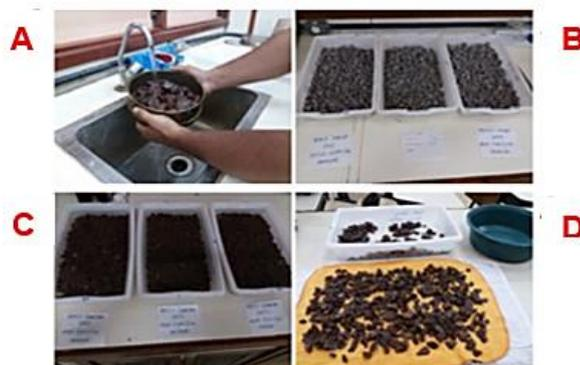
Figura 19. Ensaio de Massa Específica e Absorção NBR NM 53/2009 e teor de umidade NBR NM 9939/87 no Laboratório de Pavimentação – LABPAV da UFAM
