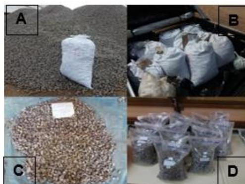
Figura 13. Coleta de material em campo (amostragem) NBR NM 26/2009.
