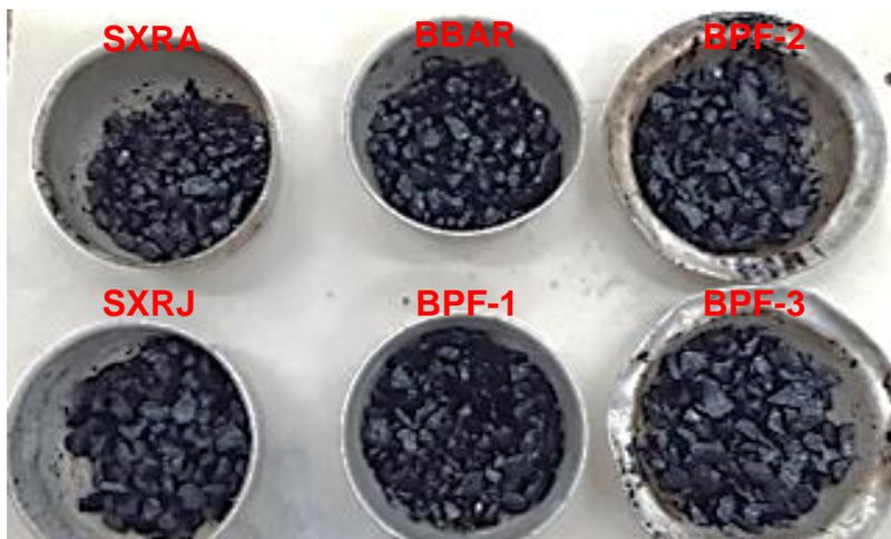
Figura 44. Ensaio de adesividade com ligante asfáltico
