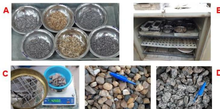
Figura 25. Ensaio de Durabilidade por emprego de sulfato de sódio – Sanidade DNER ME 096/94.
