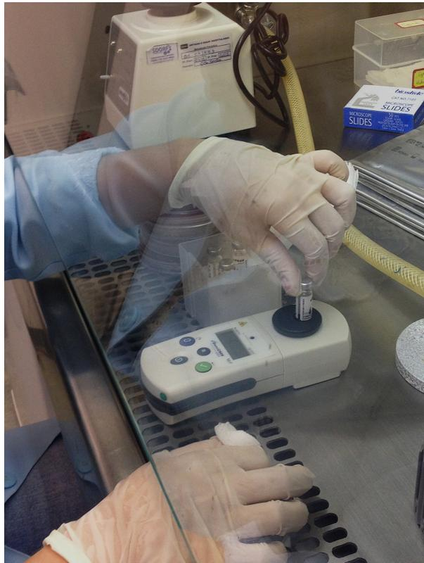
Figura 18: Calibração do Densicheck.
