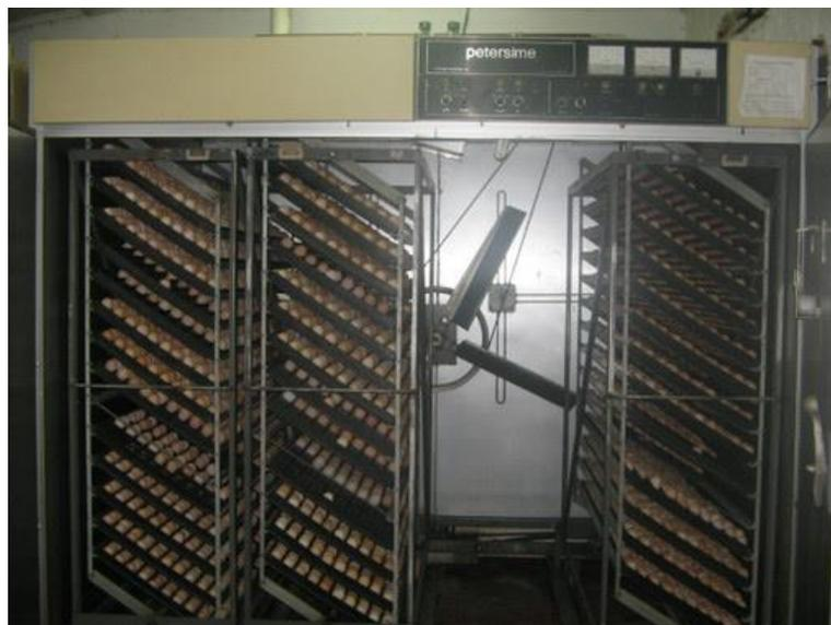
Figura 3 - Máquina de incubação realizando a viragem dos ovos
