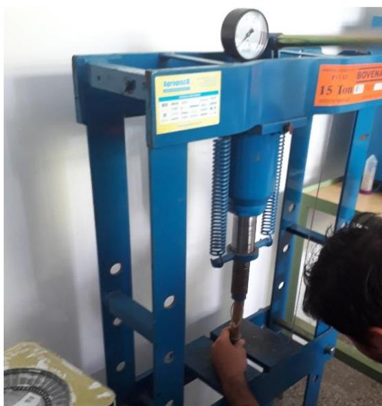
Figura 26 - Desmoldagem de corpo de prova de compressão.
