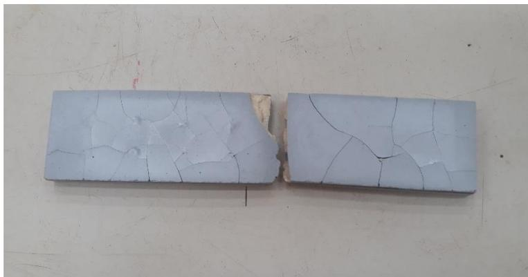
Figura 46 - Trincas no compósito após os ensaios físicos.
