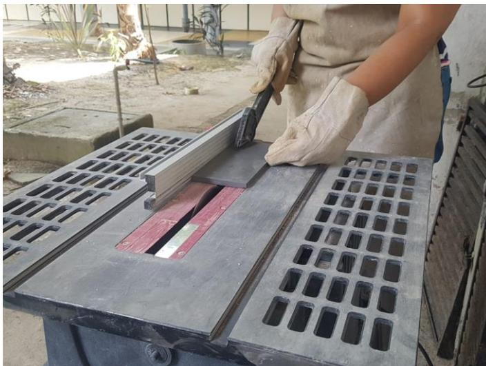
Figura 33 - Corte dos corpos de prova.
