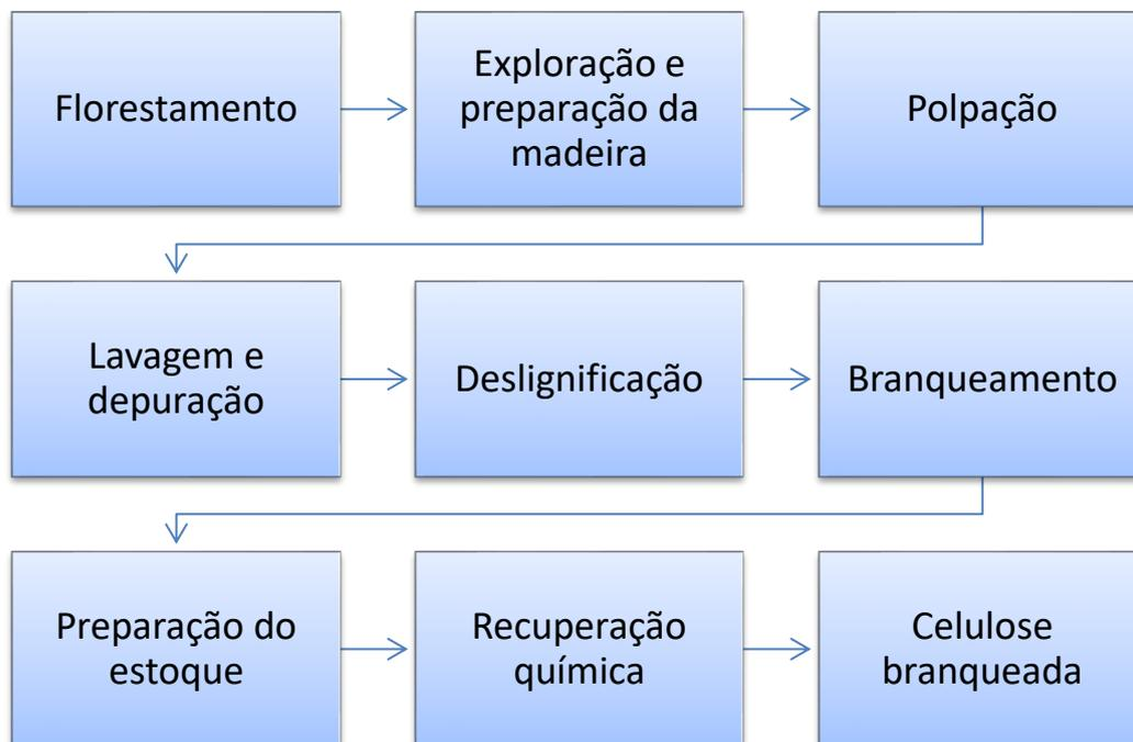
Figura 6- Visão geral do processo de produção da celulose.
