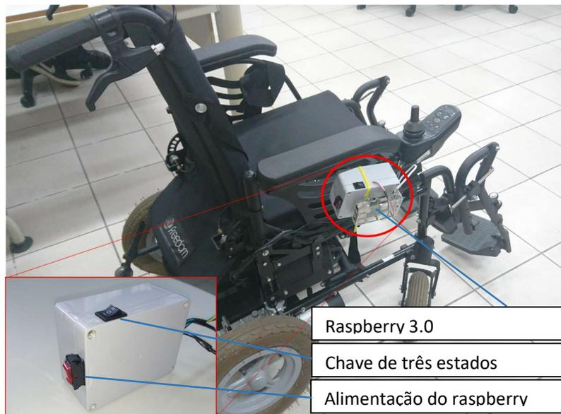
Figura 35 - Cadeira de rodas motorizada com sistema embarcado
