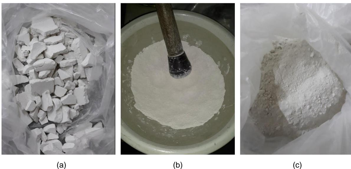
Figura 3:6: Processos de beneficiamento do caulim: a) Material seco; b) Destorroamento manual do material seco; c) Material final para calcinação.
