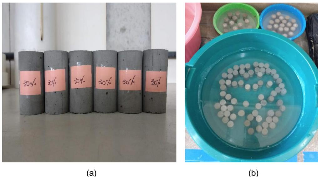
Figura 3:11: a) Corpos de prova cilíndricos produzidos; b) Amostras em cura úmida
