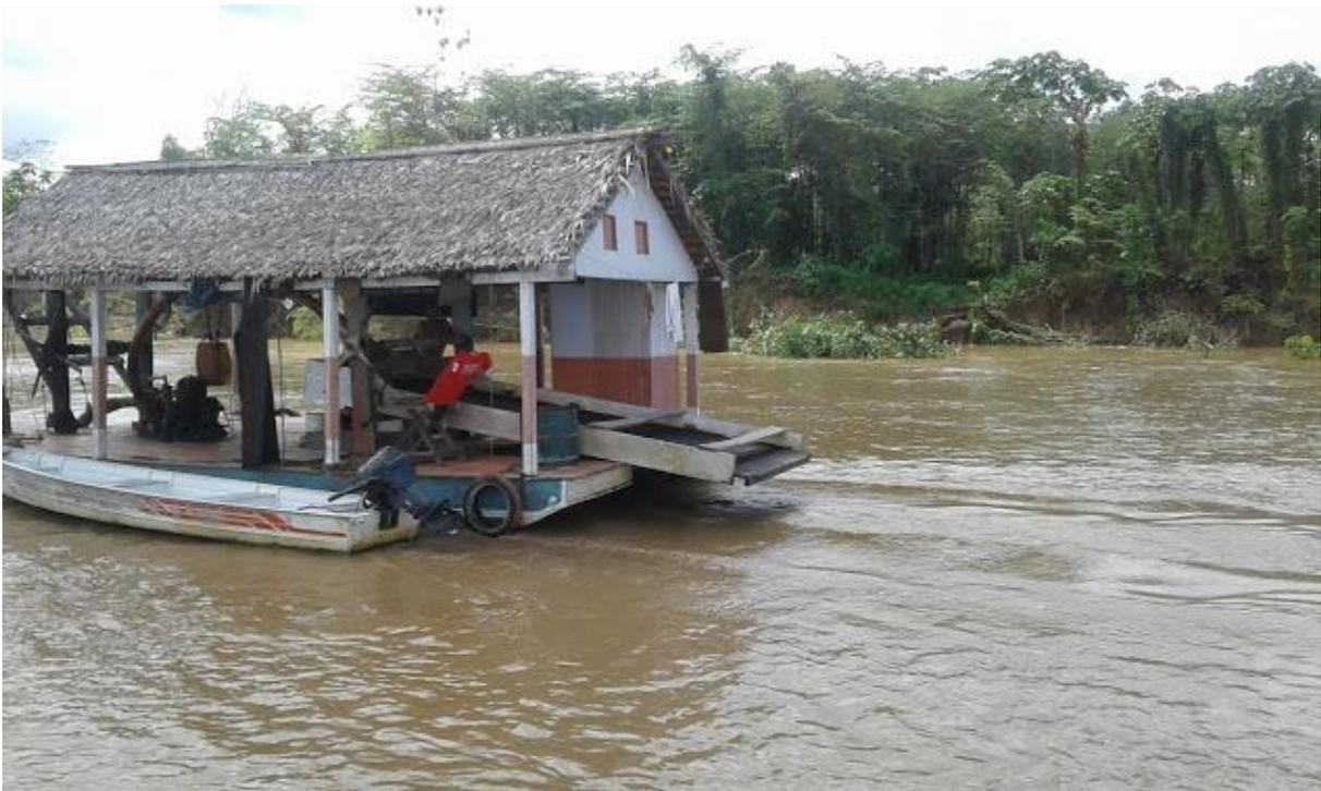
Figura 11: Flutuante de Extração de ouro
