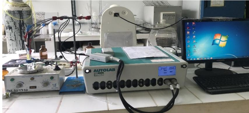
Figura 6 - Computador acoplado ao potenciostato e ao sistema de três eletrodos
