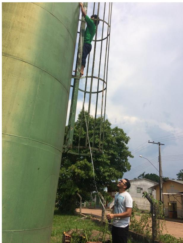
Figura 5.7: Alunos medindo a altura da parte vazia da caixa
