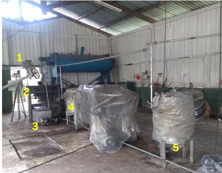
Figura 31: Máquinas dispostas dentro da Usina do Roque. (1) Prensa; (2) Filtro prensa; (3) Cozinhador; (4) Tanque decantador; (5) Tanque homogeneizador. Fonte: Terena Vidal (2019).
