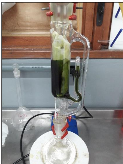
Figura 15: Sistema de extração soxhlet em funcionamento. Fonte: O Autor.
