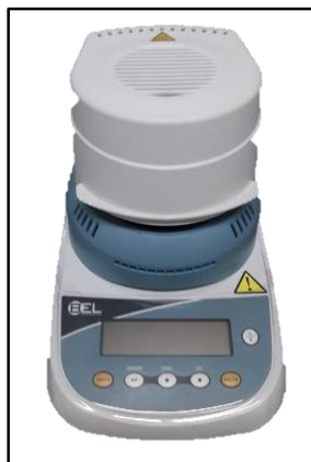
Figura 12: Balança para determinação de umidade. Fonte: O Autor.
