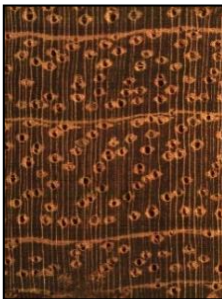
Figura 3. Macrofotografia do plano transversal (10 X) de Hymenaea courbaril L.
