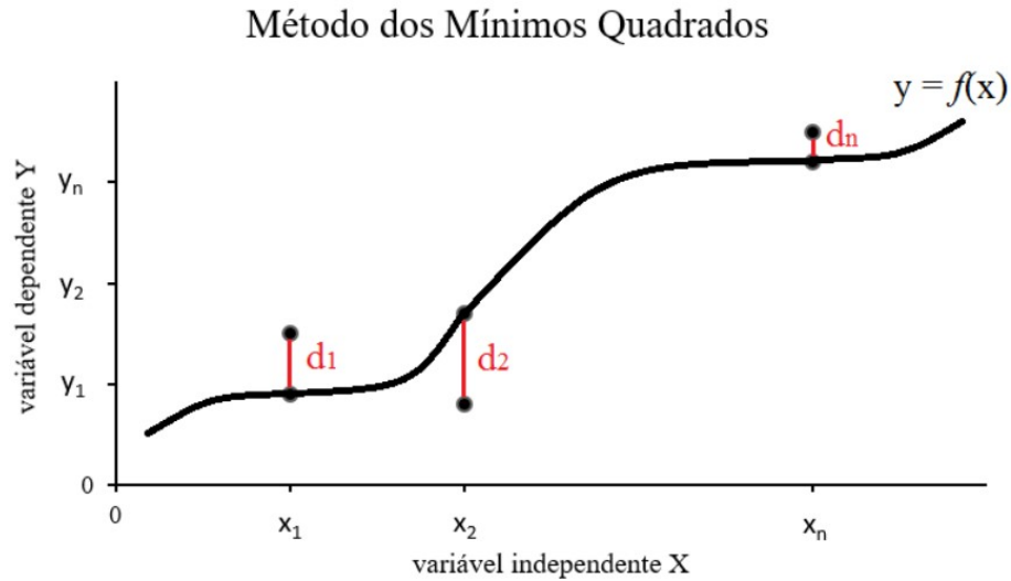
Figura 2 – Função representada pelos pontos e aproximados por uma curva y = f(x) .
