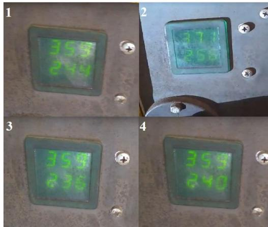
Figura 3 - Valores para corrente (A) e tensão (V) do primeiro cordão do corpo de prova G5
