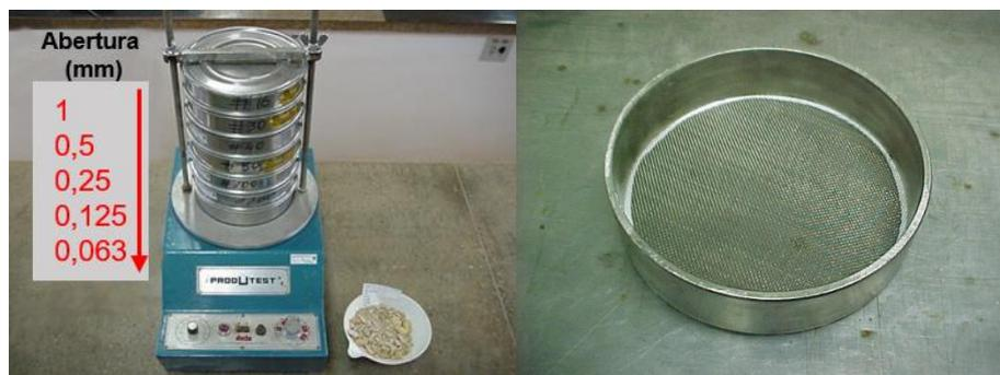
**Figura 6 - Peneiras e mesa vibratória utilizadas na análise granulométrica.**
