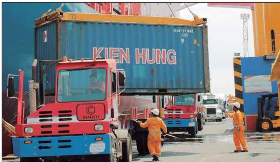
Figura 12: Trabalhadores realizando a peação e despeção de contêiner com “vara de ferro” no porto Superterminais. Fonte: OGMO/MAO, Pesquisa de Campo 2014.
