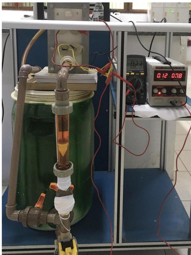
Figura 26: Fotografia de reator eletroquímico de fluxo em meso escala.
