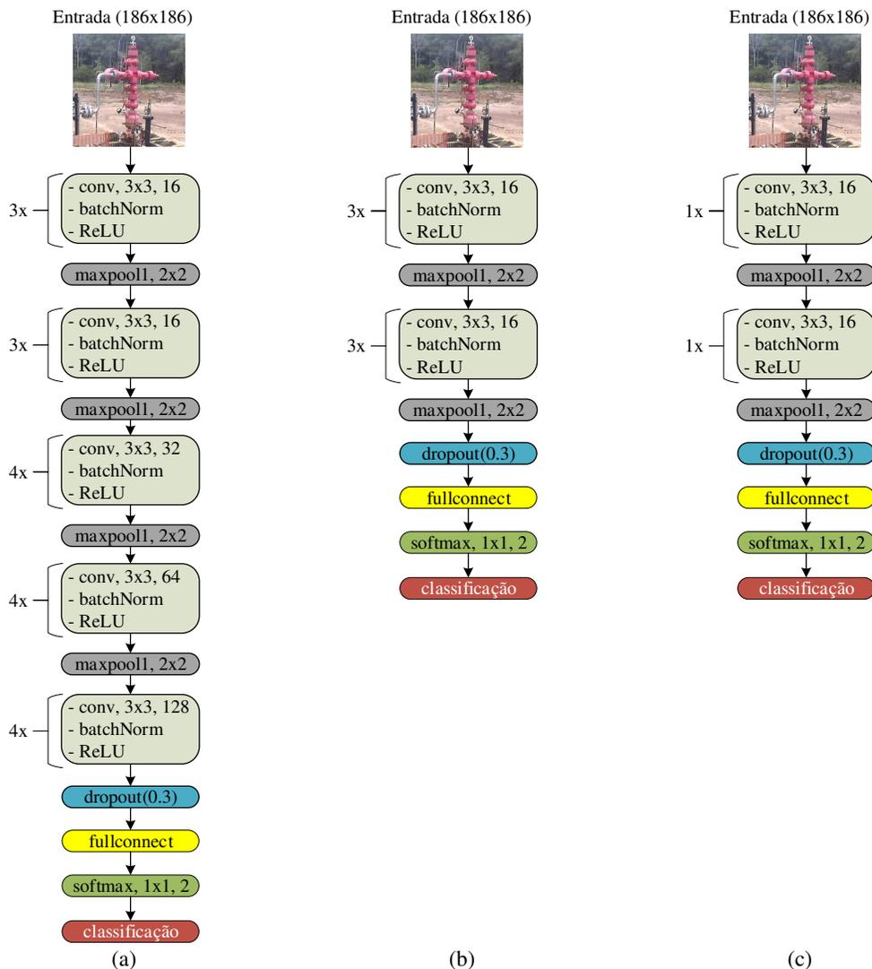
Figura 4.6 - Arquiteturas de rede propostas: a) CNNL, com 18 camadas de convolução; b) CNNM, com 6 camadas de convolução; c) CNNS, com 2 camadas de convolução. Fonte: Adaptada de Miyagawa *et al.*(2019).
